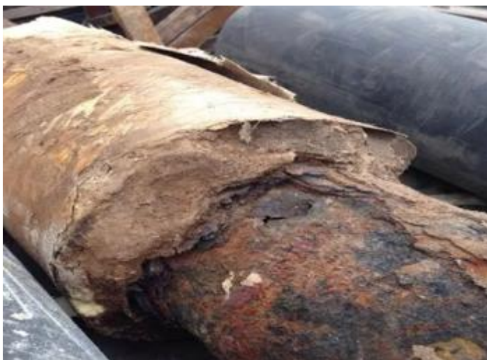
图 5-1 供热管线老化腐蚀
